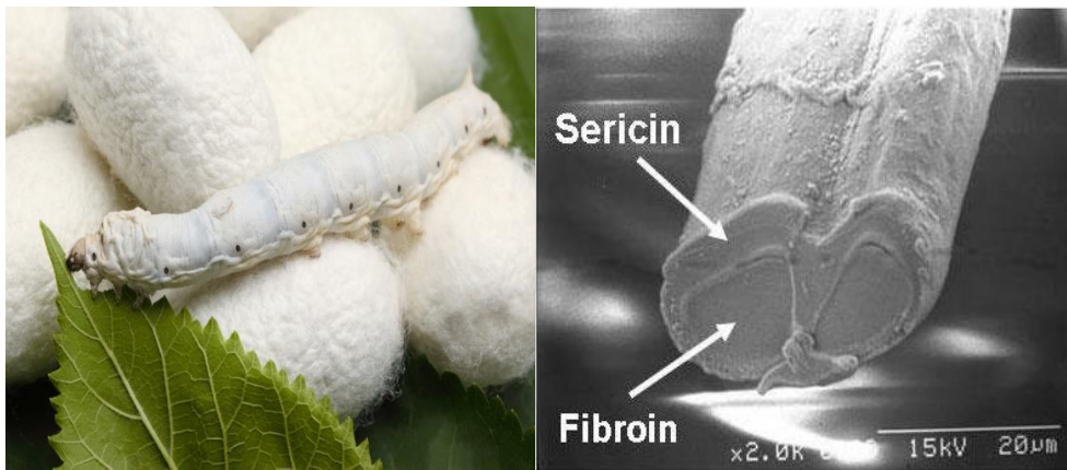
Şekil 1. İpek kozaları (sol) ve ipek demetlerinin taramalı elektron mikroskop (SEM) görüntüsü (sağ)
