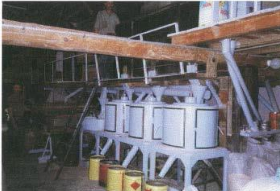
Şekil 10: Tosya’da bir çeltik fabrikası ve kavuzlu çeltiğin kavuzlarından ayrılarak parlatıldığı makine (K: Tanrıku).
