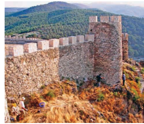
Resim 16: Sinop Boyabat Kalesi sismik kırılma etüdü
