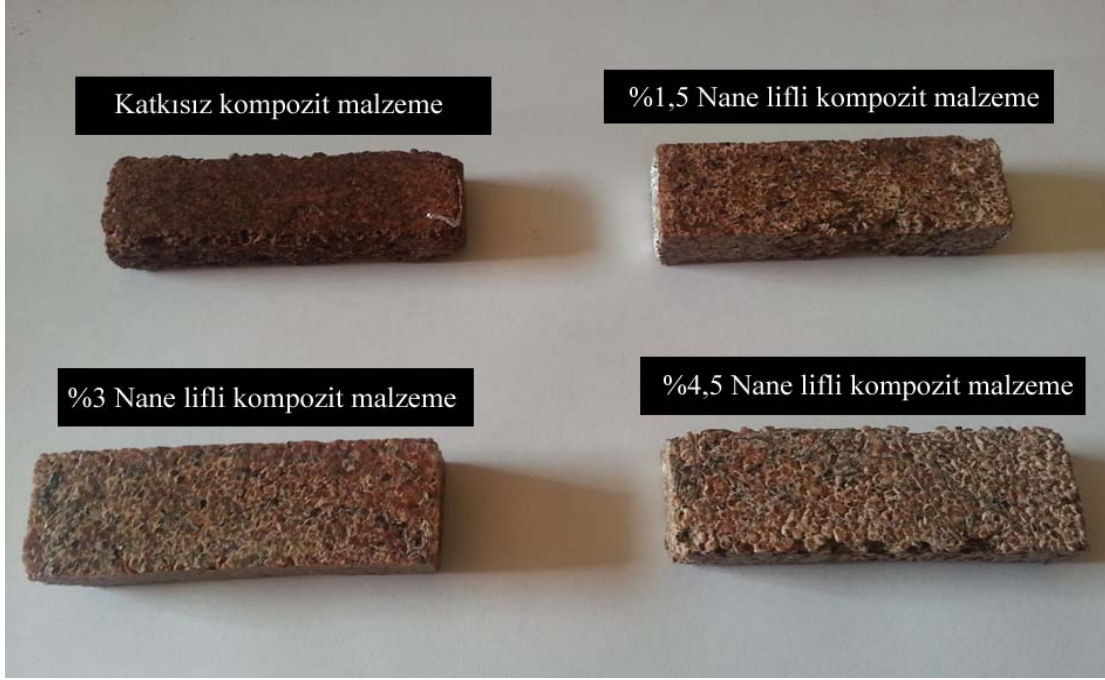
Şekil 3. Eğme testinde kullanılan numunelerinin görüntüleri (Image of samples used in 3 point bending tests)
