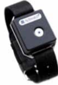
Resim 2: Kola takılan aktigrafi cihazı
