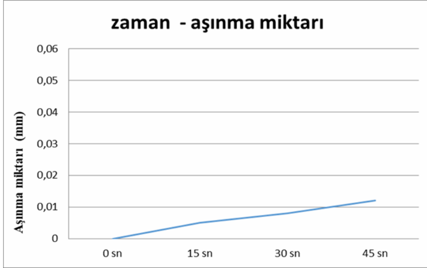
Grafik 16. Beton zeminde – 32 psi basınçta – 10 kg ağırlıkta 1100 d/d
