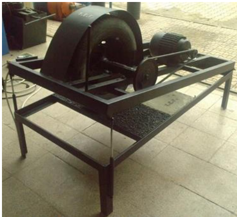
Şekil 4. Patinaj ve Kaymaya maruz kalan Lastik test cihazı
