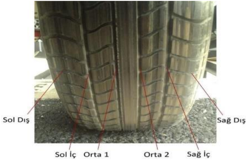
Şekil 7. Aşınmış lastik kanalları
