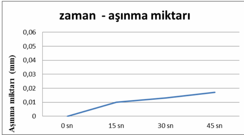
Grafik 8. Asfaltta – 32 psi basınçta – 20 kg ağırlıkta 1100 d/d
