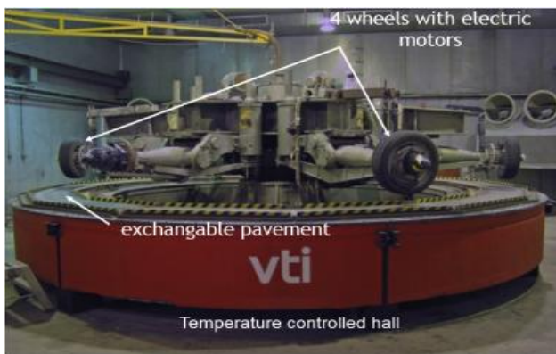
Şekil 1. Araştırma Enstitüsü(VTI) Yol Simülatörü
