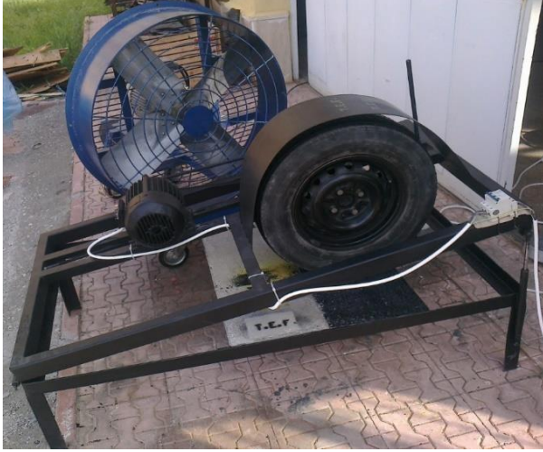
Şekil 6. Patinaj ve Kaymaya Maruz kalan test düzeneği ve soğutma için kullanılan Fan sistemi
