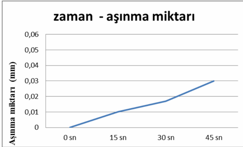
Grafik 3. Asfaltta – 28 psi Basınçta – 30 kg ağırlıkta – 1100 d/d
