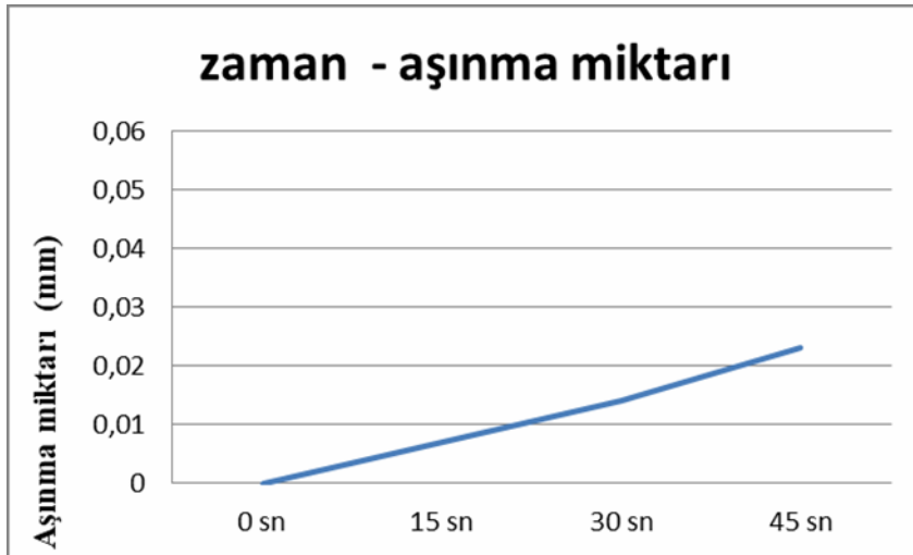
Grafik 10. Beton zeminde – 28 psi basınçta – 10 kg ağırlıkta – 1100 d/d
