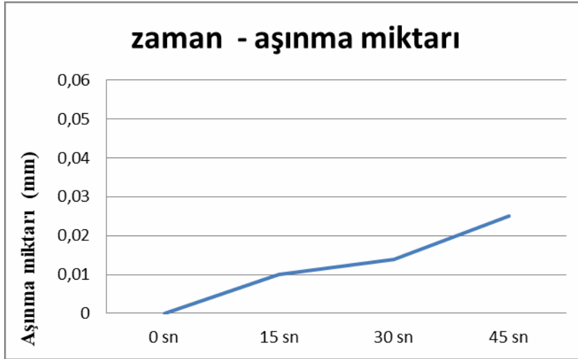
Grafik 11. Beton zeminde – 28 psi basınçta – 20 kg ağırlıkta - 1100 d/d
