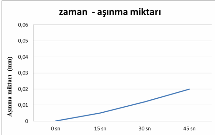
Grafik 18. Beton zeminde – 32 psi basınçta – 30 kg ağırlıkta 1100 d/d
