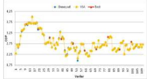
Şekil 7. YSA'nın tahmini COP_{sis} değerleri ile deneyden alınan gerçek COP_{sis} değerlerinin değişimi (Change of the estimated COP_{sis} values of the ANN with the actual COP_{sis} values obtained from the experiment)
