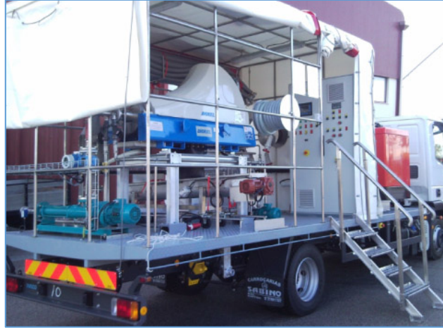
Şekil 8. Tipik mobil çamur yoğunlaştırıcı [17].
