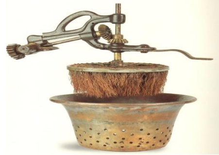
Fotoğraf 164: Sufli Tzivres fabrikası koza çözme makinesi
