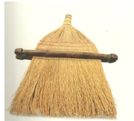
Fotoğraf 142: Süpürge dikmek için sıkıştırma aracı
