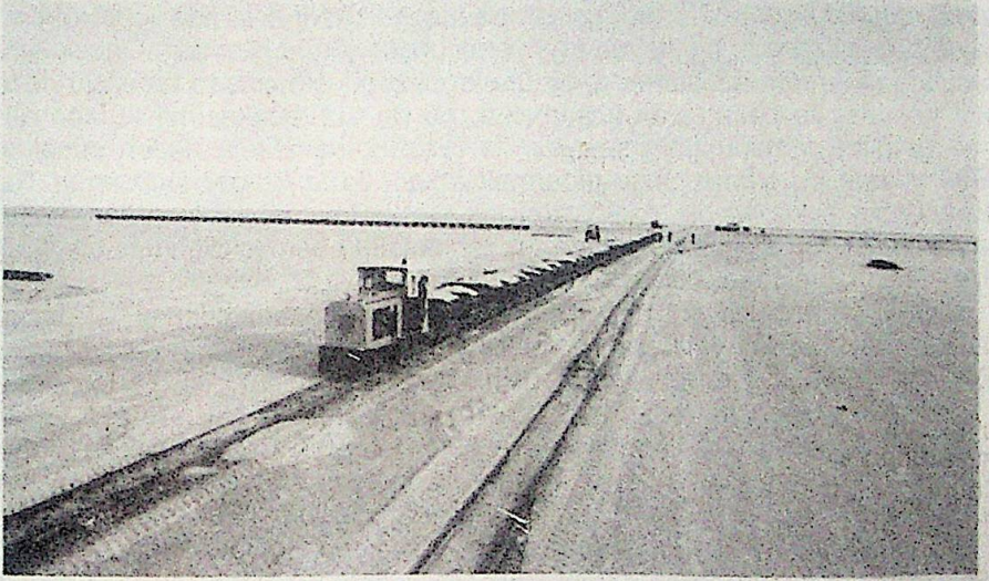
Fotoğraf 1. Tuz üretim sahasında tuzun taşınması dekovil hattı ile olmaktadır (Yavşan tuzlası).
