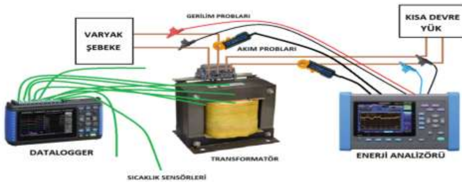
Şekil 1. Deney donanımları ve ölçüm sisteminin bağlantısı (Experimental assembly and measurement system)
