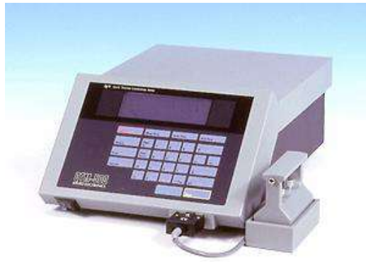
Şekil 3. Isı iletkenlik katsayısının QTM-500 cihazı ile ölçülmesi(Sefil 2010-11).
