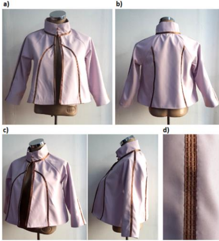
Şekil 9. Ultrasonik dikiş detaylı ceketin a) önden görüntüsü, b) arkadan görüntüsü, c) yandan görüntüsü, d) dikiş detayı.
