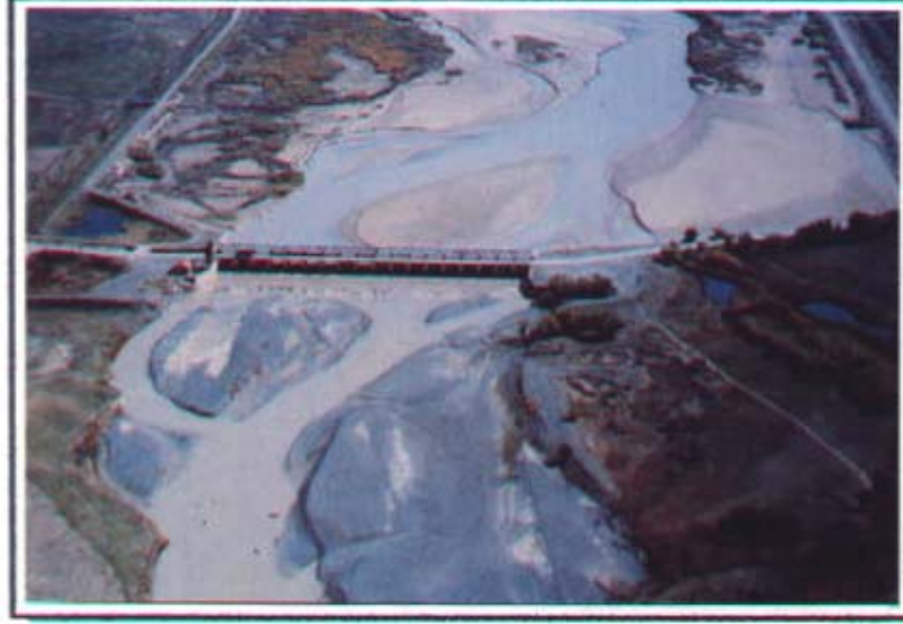
Foto:1- Tarım alanlarının sulanmasında en büyük paya sahip olan Mertekli Regülatörünün görünüşü. Bu regülatör gerisinde toplanan Fırat'ın suları, ana sulama kanallarına alınarak ve pompa istasyonları vasıtasıyla, özellikle sağ sahilde kalan, geniş tarım alanlarının sulanmasında kullanılmaktadır.
