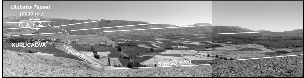
Foto 2: Kurucaova'yı güneyden sınırlandıran sol yanal atımlı DAF, kuzeyden sınırlandıran Sürgü Fayı, Kurucaova yerleşmesini tehit eden Tucak Dere ve yelpazesi ile fay kaması havzası (Fault wedge basin) tipinde oluşan Kurucaova'nın genel görünümü
