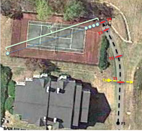
Şekil 4. Haritası çıkarılan yörünge P1-P62 noktaları arasındadır. 6 farklı test senaryosu da T1, ..., T6 olarak gösterilmektedir. Buradaki elips ve daireler görüntü toplanan bölge ve noktaları, kesik çizgiler de görüntü toplanan yörüngeleri temsil etmektedir. Haritalanan yörüngeye ilk noktanın GPS koordinatları: [36° 4'31.26"N, 86°55'38.30"W]
