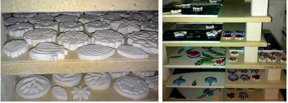
Şekil 2: Modüler motiflerin bisküvi pişiriminden görünüm (solda); Karoların sıvı pişirimi sonrasında fırındaki son durumları (sağda).
