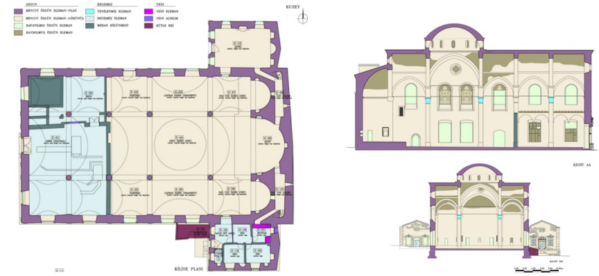
Görsel 5. Tarihi yapının geçirdiği değişiklikler ve eklentiler- Plan ve Kesitler
