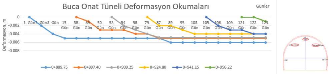
Şekil 7. Tünel içinde sağ omuzdaki deformasyon ölçümleri
