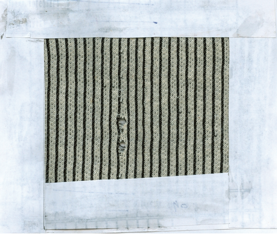
Şekil 5: İğne ayağının kırılmasıyla oluşan hata
