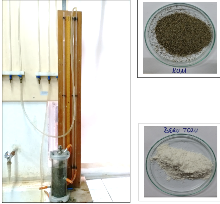
Şekil 3. Permeabilite deney düzeneęi ve kum zemin-atık boru tozu
