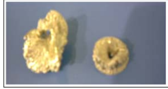
Şekil 6. Çıkıntı aparatı ucunda meydana gelen metal yığılması (Metal built up at the end of protrusion apparatus)
