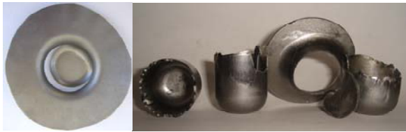
Şekil 4. Değişik yırtılma ve çatlakların olduğu numuneler (Various tearing and crackings which was occurred in specimens)
