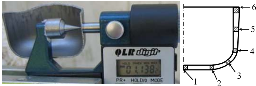
Şekil 3. Et kalınlığının ölçülmesi ve ölçüm yapılan bölgeler (Wall thickness was measured and measurement zones)
