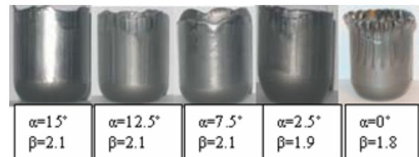
Şekil 7. R=8 mm için kalıp açısı değişimine bağlı numuneler (Specimens connecting to \alpha for R=8 mm)
