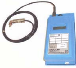
Şekil 6. Basınç ölçer ve kaydedicisi (Pressure transient kit)
