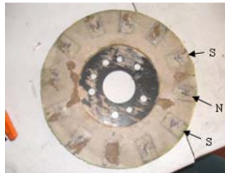
Şekil 5. Epoksiye gömülmüş mıknatıslarla bir rotor diskinin görünümü (View of a rotor disc with magnets buried in the epoxy)
