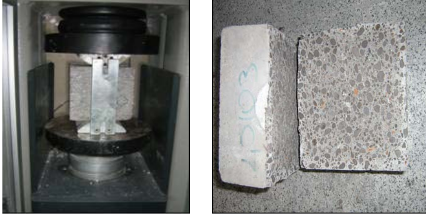
Şekil 4. Yarmada çekme deneyi ve deney sonunda kırılan numuneye ait resim (Split tensile strength test and the image of the broken sample after the test)
