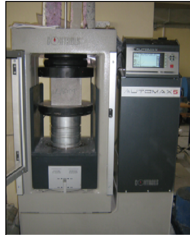
Şekil 3. Beton basınç dayanımı test cihazı (Test machine of the concrete compressive strength)
