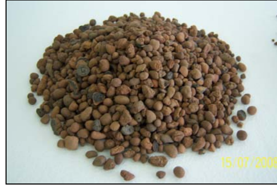
Şekil 1. Beton karışımlarında kullanılan 4-8 mm dane çapındaki GKA (4-8 mm expanded clay aggregate used in the concrete mixtures)
