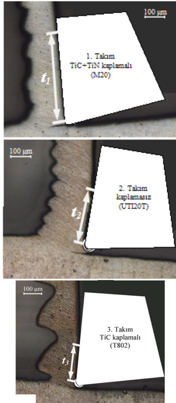
Şekil 5. Talaş kökü resimleri (Pictures of chip root)
