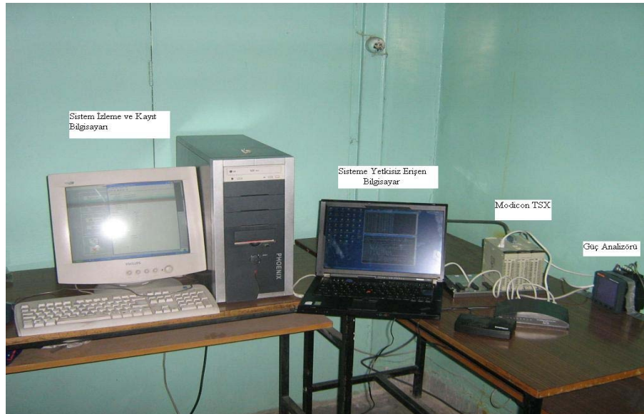
Şekil 5. Enerji izleme sistemine yetkisiz erişim (Unauthorized access to energy tracking system)
