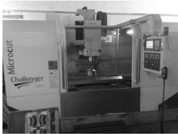
Şekil 3. Microcut 1000 CNC dik işleme (solda), iş parçası ve kesici takım bağlantı şekli (sağda) (Figure 3. Microcut 1000 CNC vertical machining (left), workpiece and cutting tool connection shape (right))
