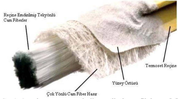
Şekil 4. Pultrüzyon metodu ile üretilmiş profil detayı [5] (Details of profile manufactured by Pultrusion method) [5]
