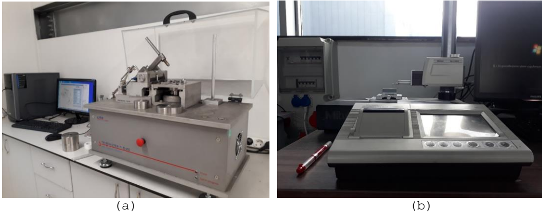
Şekil 3. (a) UTS Tribometer test cihazı ve (b) yüzey profilometre cihazı
