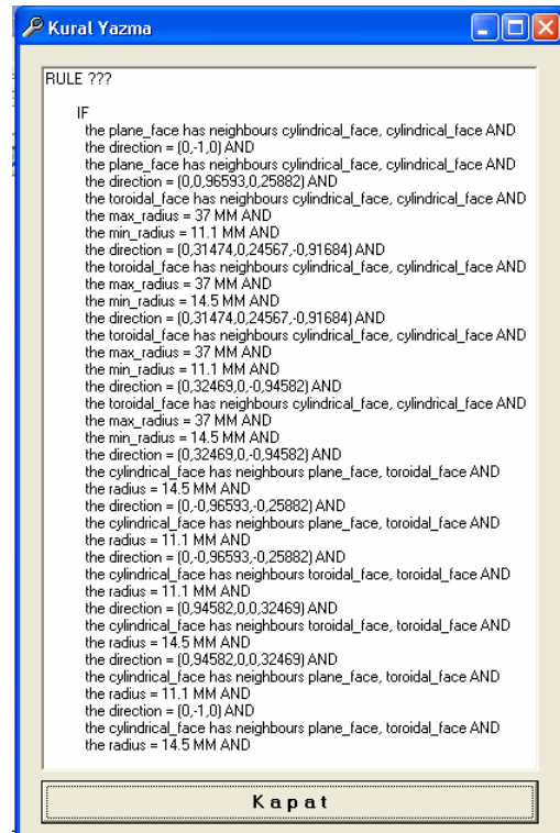
Şekil 9. Yağ buhar borusunun isteğe bağlı kural yazma modülü ile elde edilen kural penceresi (The rule window generated by the automatic rule writing module of the pipe for oil steam)
