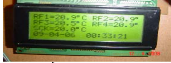
Şekil 10. ÇNSÖ sistemine ait sıcaklık bilgileri (Data belong to multi point temperature measurement system)
