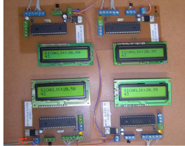
Şekil 11. RF sıcaklık iletim modüllerindeki sıcaklık bilgileri (Temperature data on RF temperature transmitter module)
