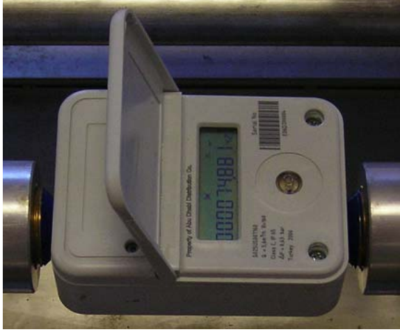
Şekil 1. Tasarım ve uygulaması yapılan ultrasonik akış ölçer
