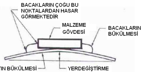
Şekil 1. Titreşim yükü altında aksel bacaklı kapasitörün bacalarındaki bükülme (Bending of lead wires of axial leaded capacitor under vibration) [4].
