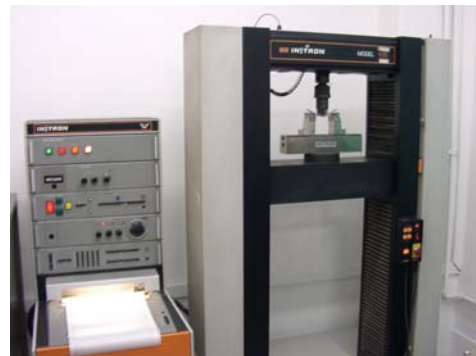
Şekil 4. Üç nokta bükme testleri düzeneği (Three point bending test setup)
