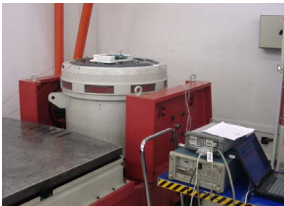
Şekil 7. Baskı devre kartın elektrodinamik sarsıcısı üzerinde basamaklandırılmış gerilme testleri (Step Stress Testing of the PCB using electrodynamic vibration shaker)
