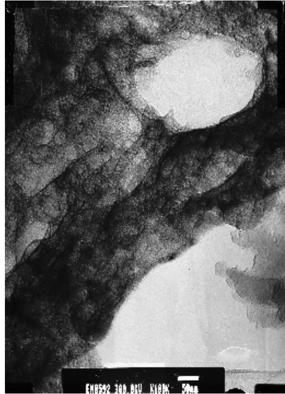
Şekil 7. 1200 MPa preslenen ve 32 saat sinterlenmiş numuneden hazırlanmış folyoya ait aydınlık alan görüntüsü x 100000
