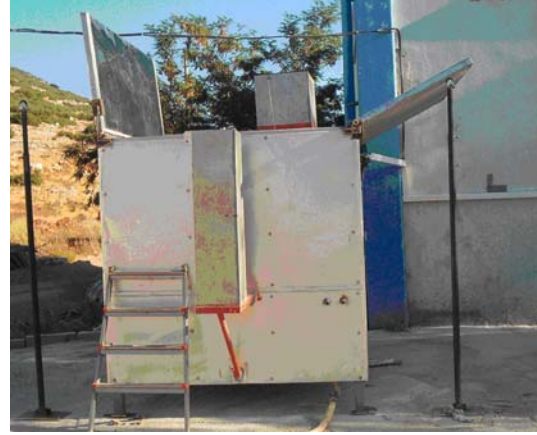
Şekil 2. Kapaklı güneş havuzu (Covered solar pond)
