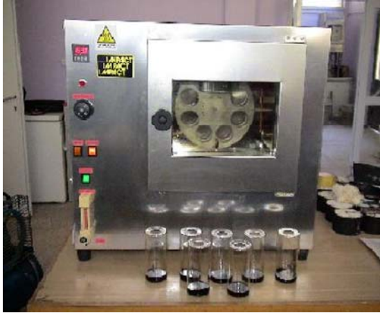
Şekil 2. Dönel ince film halinde ısıtma deney aleti (Rolling thin film oven test device)
