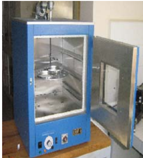
Şekil 1. İnce film halinde ısıtma deney aleti (Thin film oven test device)
