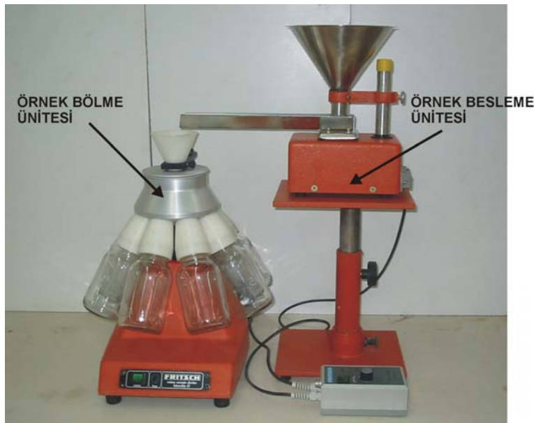
Şekil 1. Elektrikli örnek bölme cihazı (electrical sample divider)
