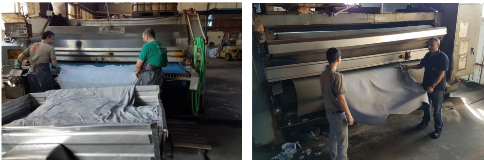
Fotoğraf 6. Sıkma makinası ve sıkma işlemi (Image 6. Sammying machine and sammying operation)
