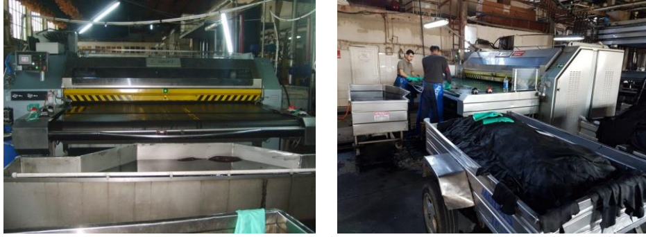
Fotoğraf 9. Açkı-sıkma makinası ve açkı-sıkma işlemi (Image 9. Set-out machine and setting-out operation)
