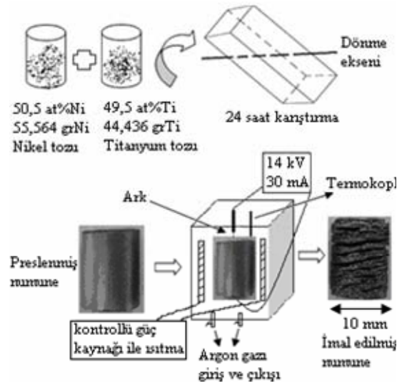
Şekil 1. Gözenekli NiTi ŞHA'nın üretiminde kullanılan SHS reaksiyonunun şematiki (Schematic of SHS reaction used for fabrication of porous NiTi SMA)
