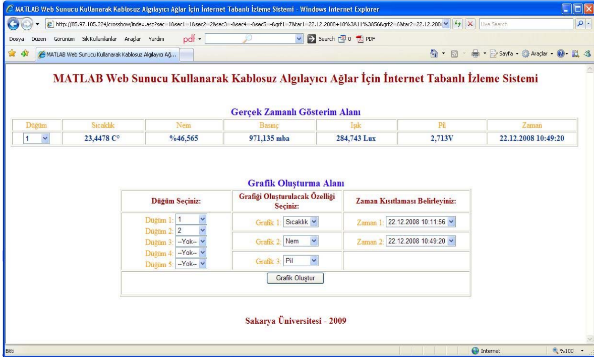
Şekil 5. Geliştirilen internet tabanlı uzaktan izleme sistemi arayüzü (The interface of developed internet-based remote monitoring system)
