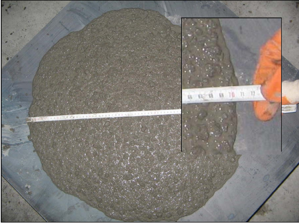
Şekil 1. Slump yayılma deneyi (Experiment of slump flow)
