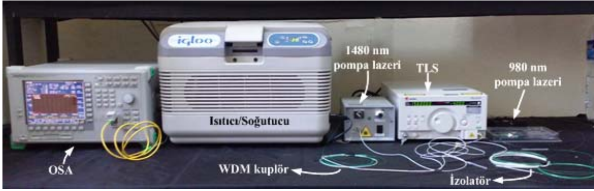
Şekil 16. EDFA deney düzeneği (EDFA experimental setup)
