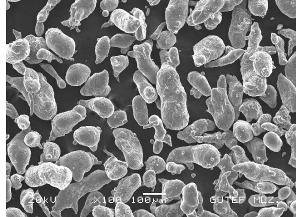
Şekil 1. MA işleminde kullanılan işlem görmemiş tozlar (Raw powders that used in MA process)
