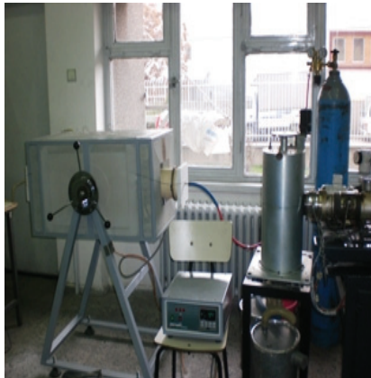
Şekil 11. Sinterleme fırını ve uygulanan sıcaklık profili (Sintering furnace and applied temperature profile)
