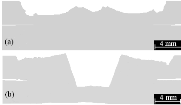
Şekil 7. Takım bekleme süresinin kaynak dikişi oluşumundaki etkisi. (a) Beklemesiz kaynak ve (b) 30 saniye beklemeli kaynak. (The effect of tool retracting delay on weld cross section, (a) No delay and (b) 30 seconds delay)
