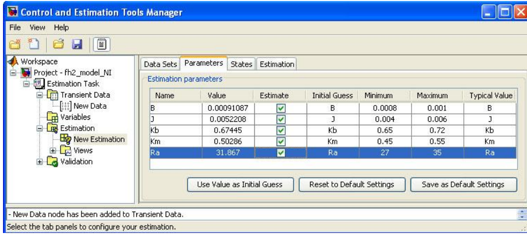
Şekil 11. Parameter Estimation araç kutusunda model parametrelerinin ve değer aralıklarının belirlenmesi (Defining parameters and value ranges in Parameter Estimation toolbox)
