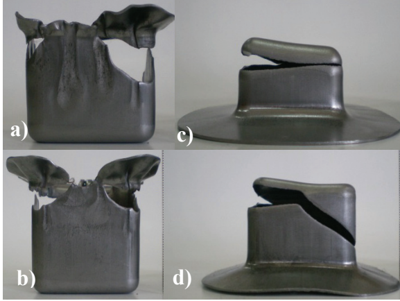
Şekil 5. Değişik yırtılma ve çatlak hasarlarının olduğu numuneler a-b kap üst kısmında, c-d zımba radyüsünde (Different specimens with various tearing and cracking defects)
