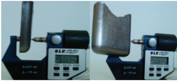
Şekil 3. Et kalınlığının ölçülmesi (The measurement of wall thickness)
