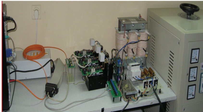
Şekil 13. D-STATKOM deneyel kurulumu (Experimental setup of D-STATCOM)
